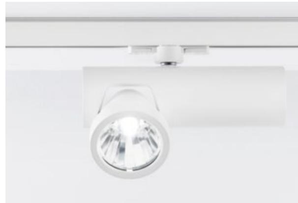
Aufbaustrahler mit LED, passive Kühlung, Bemessungslebensdauer der LED L80/B10 > 50.000 h für 15 W und L70/B10 > 50.000 h für 28 W, Farborttoleranz 3 SDCM (initial), Reflektor Reinstaluminium 99,99 % in MIRO-SILVER®, Strahler drehbar, Leuchtenkopf schwenkbar, Leuchtgehäuse Aluminium-Druckguss, pulverbeschichtet, Multiadapter, inklusive Abschlussglas, Leuchtenfarben Stratoschwarz, -weiß, Schutzart IP 20, Schutzklasse I, max. Anzahl der Leuchten pro Stromkreis 34 Stk./B16A
