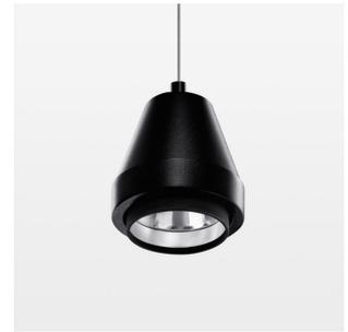
Pendelleuchte mit LED, Bemessungslebensdauer der LED L80/B10 > 50000 h, Farbwiedergabeindex CRI > 80, Farborttoleranz 2 SDCM (initial), Reflektor mit kreisförmigem Lichtbild, Reflektor Reinstaluminium 99,99% in MIRO-Silver®, segmentiert und facettiert, 3D-Linse Silikon, zur Reduzierung des Streulichtanteils, Leuchtenkopf Aluminium-Druckguss, pulverbeschichtet, Schwarz
