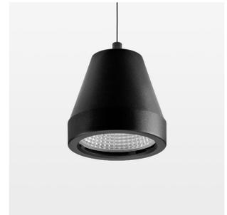
Pendelleuchte mit LED, Bemessungslebensdauer der LED L80/B10 > 50000 h, Farbwiedergabeindex CRI > 90, Farborttoleranz 2 SDCM (initial), Reflektor mit kreisförmigem Lichtbild, Reflektor Reinstaluminium 99,99% in MIRO-Silver®, segmentiert und facettiert, Leuchtenkopf Aluminium-Druckguss, pulverbeschichtet, Schwarz
