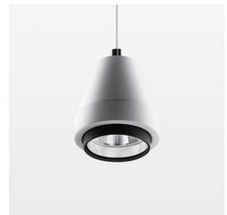
Pendelleuchte mit LED, Bemessungslebensdauer der LED L80/B10 > 50000 h, Farbwiedergabeindex CRI > 96, Farborttoleranz 2 SDCM (initial), Reflektor mit kreisförmigem Lichtbild, Reflektor Reinstaluminium 99,99% in MIRO-Silver®, segmentiert und facettiert, 3D-Linse Silikon, zur Reduzierung des Streulichtanteils, Leuchtenkopf Aluminium-Druckguss, pulverbeschichtet, Weiss
