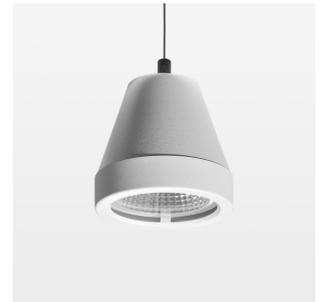
Pendelleuchte mit LED, Bemessungslebensdauer der LED L80/B10 > 50000 h, Farbwiedergabeindex CRI > 80, Farborttoleranz 2 SDCM (initial), Reflektor mit kreisförmigem Lichtbild, Reflektor Reinstaluminium 99,99% in MIRO-Silver®, segmentiert und facettiert, Leuchtenkopf Aluminium-Druckguss, pulverbeschichtet, Weiss
