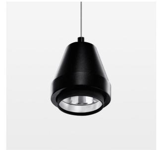
Pendelleuchte mit LED, Bemessungslebensdauer der LED L80/B10 > 50000 h, Farbwiedergabeindex CRI > 90, Farborttoleranz 2 SDCM (initial), Reflektor mit kreisförmigem Lichtbild, Reflektor Reinstaluminium 99,99% in MIRO-Silver®, segmentiert und facettiert, 3D-Linse Silikon, zur Reduzierung des Streulichtanteils, Leuchtenkopf Aluminium-Druckguss, pulverbeschichtet, Schwarz
