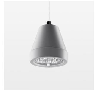
Pendelleuchte mit LED, Bemessungslebensdauer der LED L80/B10 > 50000 h, Farbwiedergabeindex CRI > 90, Farborttoleranz 2 SDCM (initial), rotationssymmetrischer Reflektor mit kreisförmigen Lichtbild, Reflektor Reinstaluminium 99,99% in MIRO-Silver®, segmentiert und facettiert, 3D-Linse Silikon, zur Reduzierung des Streulichtanteils, Leuchtenkopf Aluminium-Druckguss, pulverbeschichtet, Silber
