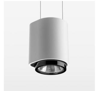
Pendelleuchte mit LED, Bemessungslebensdauer der LED L80/B10 50000 h (Tambient 25°C), Farbwiedergabeindex CRI > 90, Farborttoleranz 2 SDCM (initial), Reflektor mit ovalem Lichtbild, LED Hybrid-Technologie, 3D-Linse Silikon zur Reduzierung des Streulichtanteils, Reflektor Reinstaluminium 99,99% in MIRO-Silver®, segmentiert, wechselbare Reflektoreinheit aus Kunststoff, schwarz, hochglänzend, inkl. Abschlußglas, Leuchtengehäuse Aluminium-Druckguss, pulverbeschichtet, weiß
