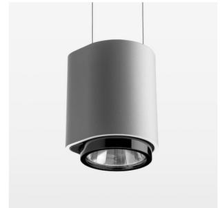
Pendelleuchte mit LED, Bemessungslebensdauer der LED L80/B10 50000 h (Tambient 25°C), Farbwiedergabeindex CRI > 80, Farborttoleranz 2 SDCM (initial), Reflektor mit ovalem Lichtbild, LED Hybrid-Technologie, 3D-Linse Silikon zur Reduzierung des Streulichtanteils, Reflektor Reinstaluminium 99,99% in MIRO-Silver®, segmentiert, wechselbare Reflektoreinheit aus Kunststoff, schwarz, hochglänzend, inkl. Abschlußglas, Leuchtengehäuse Aluminium-Druckguss, pulverbeschichtet, silber
