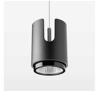
Pendelleuchte mit LED, Bemessungslbensdauer der LED L80/B10 50000 h (Tambient 25°C), Farbwiedergabeindex CRI > 95, Farborttoleranz 2 SDCM (initial), rotationssymmetrischer Reflektor mit kreisförmigen Lichtbild, Reflektor Reinstaluminium 99,99% in MIRO-Silver®, segmentiert und facettiert, wechselbare Reflektoreinheit aus Kunststoff, schwarz, hochglänzend, inkl. Abschlußglas, Leuchtgehäuse Aluminium-Druckguss, pulverbeschichtet, schwarz
