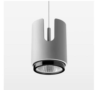
Pendelleuchte mit LED, Bemessungslebensdauer der LED L80/B10 50000 h (Tambient 25°C), Farbwiedergabeindex CRI > 80, Farborttoleranz 2 SDCM (initial), rotationssymmetrischer Reflektor mit kreisförmigen Lichtbild, Reflektor Reinstaluminium 99,99% in MIRO-Silver®, segmentiert und facettiert, wechselbare Reflektoreinheit aus Kunststoff, schwarz, hochglänzend, inkl. Abschlußglas, Leuchtgehäuse Aluminium-Druckguss, pulverbeschichtet, silber
