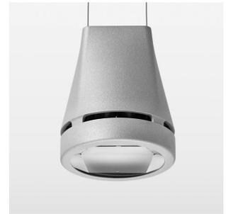
Pendelleuchte mit LED, Bemessungslebensdauer der LED L80/B10 > 50000 h, Farbwiedergabeindex CRI > 90, Farborttoleranz 2 SDCM (initial), Reflektor mit ovalem Lichtbild, Reflektor Reinstaluminium 99,99% in MIRO-Silver®, Leuchtenkopf Aluminium-Druckguss, pulverbeschichtet, silber
