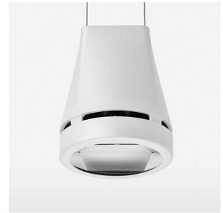
Pendelleuchte mit LED, Bemessungslebensdauer der LED L80/B10 > 50000 h, Farbwiedergabeindex CRI > 80, Farborttoleranz 2 SDCM (initial), Reflektor mit ovalem Lichtbild, Reflektor Reinstaluminium 99,99% in MIRO-Silver®, Leuchtenkopf Aluminium-Druckguss, pulverbeschichtet, Weiss
