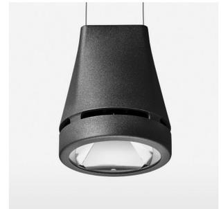
Pendelleuchte mit LED, Bemessungslebensdauer der LED L80/B10 > 50000 h, Farbwiedergabeindex CRI > 80, Farborttoleranz 2 SDCM (initial), Reflektor mit kreisförmigem Lichtbild, Reflektor Reinstaluminium 99,99% in MIRO-Silver®, Leuchtenkopf Aluminium-Druckguss, pulverbeschichtet, schwarz
