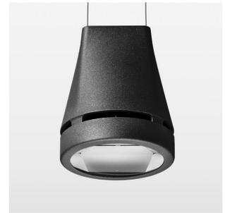
Pendelleuchte mit LED, Bemessungslebensdauer der LED L80/B10 > 50000 h, Farbwiedergabeindex CRI > 80, Farborttoleranz 2 SDCM (initial), Reflektor mit ovalem Lichtbild, Reflektor Reinstaluminium 99,99% in MIRO-Silver®, Baldachin Stahlblech, pulverbeschichtet, Leuchtenkopf Aluminium-Druckguss, pulverbeschichtet, schwarz
