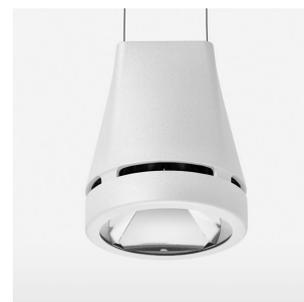
Pendelleuchte mit LED, Bemessungslebensdauer der LED L80/B10 > 50000 h, Farbwiedergabeindex CRI > 80, Farborttoleranz 2 SDCM (initial), Reflektor mit kreisförmigem Lichtbild, Reflektor Reinstaluminium 99,99% in MIRO-Silver®, Leuchtenkopf Aluminium-Druckguss, pulverbeschichtet, Weiss, separate Treibereinheit
