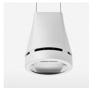
Pendelleuchte mit LED, Bemessungslebensdauer der LED L80/B10 > 50000 h, Farbwiedergabeindex CRI > 90, Farborttoleranz 2 SDCM (initial), Reflektor mit ovalem Lichtbild, Reflektor Reinstaluminium 99,99% in MIRO-Silver®, Leuchtenkopf Aluminium-Druckguss, pulverbeschichtet, Weiss, separate Treibereinheit
