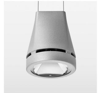
Pendelleuchte mit LED, Bemessungslebensdauer der LED L80/B10 > 50000 h, Farbwiedergabeindex CRI > 80, Farborttoleranz 2 SDCM (initial), Reflektor mit kreisförmigem Lichtbild, Reflektor Reinstaluminium 99,99% in MIRO-Silver®, Leuchtenkopf Aluminium-Druckguss, pulverbeschichtet, silber
