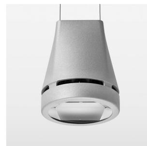
Pendelleuchte mit LED, Bemessungslebensdauer der LED L80/B10 > 50000 h, Farbwiedergabeindex CRI > 70, Farborttoleranz 2 SDCM (initial), Reflektor mit ovalem Lichtbild, Reflektor Reinstaluminium 99,99% in MIRO-Silver®, Leuchtenkopf Aluminium-Druckguss, pulverbeschichtet, silber
