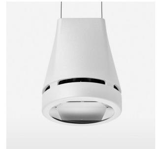
Pendelleuchte mit LED, Bemessungslebensdauer der LED L80/B10 > 50000 h, Farbwiedergabeindex CRI > 80, Farborttoleranz 2 SDCM (initial), Reflektor mit ovalem Lichtbild, Reflektor Reinstaluminium 99,99% in MIRO-Silver®, Leuchtenkopf Aluminium-Druckguss, pulverbeschichtet, Weiss, separate Treibereinheit
