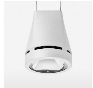
Pendelleuchte mit LED, Bemessungslebensdauer der LED L80/B10 > 50000 h, Farbwiedergabeindex CRI > 80, Farborttoleranz 2 SDCM (initial), Reflektor mit kreisförmigem Lichtbild, Reflektor Reinstaluminium 99,99% in MIRO-Silver®, Leuchtenkopf Aluminium-Druckguss, pulverbeschichtet, Weiss, separate Treibereinheit
