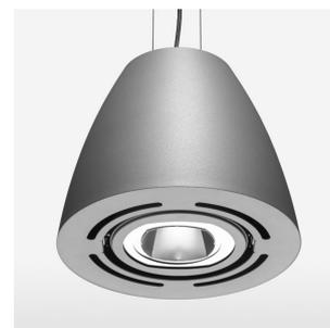
Pendelleuchte mit LED, Bemessungslbensdauer der LED L80/B10 > 50000 h, Farbwiedergabeindex CRI > 80, Farborttoleranz 2 SDCM (initial), Reflektor mit ovalem Lichtbild, Reflektor Reinstaluminium 99,99% in MIRO-Silver®, Schwenkwinkel +/-25°, Leuchtgehäuse Stahlblech, pulverbeschichtet, silber
