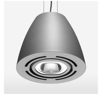
Pendelleuchte mit LED, Bemessungslebensdauer der LED L80/B10 > 50000 h, Farbwiedergabeindex CRI > 80, Farborttoleranz 2 SDCM (initial), Reflektor mit ovalem Lichtbild, Reflektor Reinstaluminium 99,99% in MIRO-Silver®, Schwenkwinkel +/-25°, Leuchtgehäuse Stahlblech, pulverbeschichtet, silber
