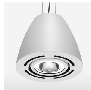
Pendelleuchte mit LED, Bemessungslebensdauer der LED L80/B10 > 50000 h, Farbwiedergabeindex CRI > 82, Farborttoleranz 2 SDCM (initial), Reflektor mit kreisförmigem Lichtbild, Reflektor Reinstaluminium 99,99% in MIRO-Silver®, Schwenkwinkel +/-25°, Leuchtgehäuse Stahlblech, pulverbeschichtet, Weiss
