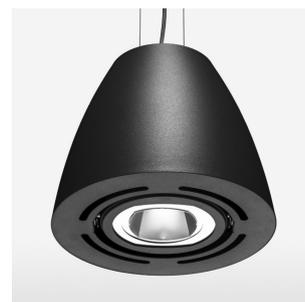
Pendelleuchte mit LED, Bemessungslebensdauer der LED L80/B10 > 50000 h, Farbwiedergabeindex CRI > 80, Farborttoleranz 3 SDCM (initial), Reflektor mit kreisförmigem Lichtbild, Reflektor Reinstaluminium 99,99% in MIRO-Silver®, Schwenkwinkel +/-25°, Leuchtgehäuse Stahlblech, pulverbeschichtet, schwarz
