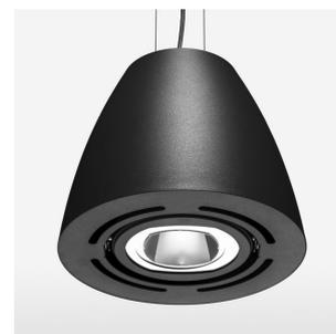
Pendelleuchte mit LED, Bemessungslebensdauer der LED L80/B10 > 50000 h, Farbwiedergabeindex CRI > 90, Farborttoleranz 2 SDCM (initial), Reflektor mit kreisförmigem Lichtbild, Reflektor Reinstaluminium 99,99% in MIRO-Silver®, Schwenkwinkel +/-25°, Leuchtgehäuse Stahlblech, pulverbeschichtet, schwarz
