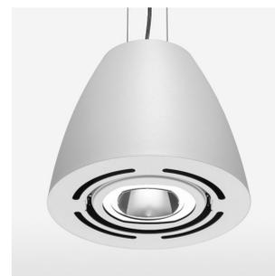
Pendelleuchte mit LED, Bemessungslebensdauer der LED L80/B10 > 50000 h, Farbwiedergabeindex CRI > 80, Farborttoleranz 2 SDCM (initial), Reflektor mit kreisförmigem Lichtbild, Reflektor Reinstaluminium 99,99% in MIRO-Silver®, Schwenkwinkel +/-25°, Leuchtgehäuse Stahlblech, pulverbeschichtet, Weiss
