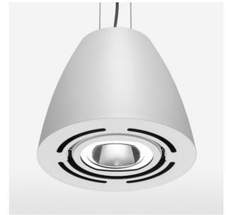
Pendelleuchte mit LED, Bemessungslebensdauer der LED L80/B10 > 50000 h, Farbwiedergabeindex CRI > 82, Farborttoleranz 2 SDCM (initial), Reflektor mit ovalem Lichtbild, Reflektor Reinstaluminium 99,99% in MIRO-Silver®, Schwenkwinkel +/-25°, Leuchtgehäuse Stahlblech, pulverbeschichtet, Weiss
