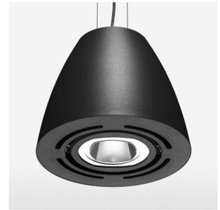
Pendelleuchte mit LED, Bemessungslebensdauer der LED L80/B10 > 50000 h, Farbwiedergabeindex CRI > 80, Farborttoleranz 2 SDCM (initial), Reflektor mit kreisförmigem Lichtbild, Reflektor Reinstaluminium 99,99% in MIRO-Silver®, Schwenkwinkel +/-25°, Leuchtgehäuse Stahlblech, pulverbeschichtet, schwarz
