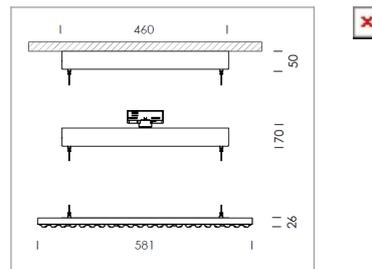
Pendelleuchte mit LED, Bemessungslebensdauer der LED L90/B50 50000 h (Tambient 25°C), Farbwiedergabeindex CRI > 80, Farborttoleranz 3 SDCM (initial), doppelt asymmetrisches Lichtbild mit deutlich erhöhter horizontaler Aufhellung, Linse aus PMMA, Leuchtengehäuse Stahlblech, pulverbeschichtet, schwarz matt, Stromführung über Abhängeseile, Baldachin / Einspeiseset (E-Set) bitte separat bestellen.
