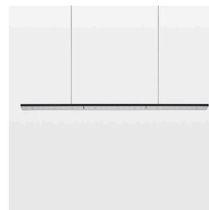
Pendelleuchte mit LED, Bemessungslebensdauer der LED L90/B50 50000 h (Tambient 25°C), Farbwiedergabeindex CRI > 80, Farborttoleranz 3 SDCM (initial), sehr breites, homogenes Lichtbild (90°), TIR-Linse aus PMMA, Leuchtgehäuse Stahlblech, pulverbeschichtet, schwarz matt, Stromführung über Abhängeseile
