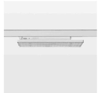
Aufbauleuchte mit LED, Bemessungslebensdauer der LED L90/B50 50000 h (Tambient 25°C), Farbwiedergabeindex CRI > 80, Farborttoleranz 3 SDCM (initial), breites, homogenes Lichtbild (60°), TIR-Linse aus PMMA, Leuchtgehäuse Stahlblech, pulverbeschichtet, weiß, Rastmechanismus zum exakten Ausrichten in 15°-Stufen, Drehwinkel 300°, In-Track-Adapter, Casambi, On/Off, 220-240 V~ / 50-60 Hz, max. Anzahl Leuchten pro Stromkreis 64 Stk. / B16A
