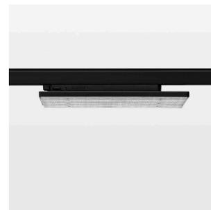
Aufbauleuchte mit LED, Bemessungslebensdauer der LED L90/B50 50000 h (Tambient 25°C), Farbwiedergabeindex CRI > 80, Farborttoleranz 3 SDCM (initial), homogenes Lichtbild 30°, TIR-Linse aus PMMA, Leuchtengehäuse Stahlblech, pulverbeschichtet, schwarz, Rastmechanismus zum exakten Ausrichten in 15°-Stufen, Drehwinkel 300°, In-Track-Adapter, Casambi, 220-240 V~ / 50-60 Hz, max. Anzahl Leuchten pro Stromkreis 64 Stk. / B16A
