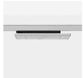
Aufbauleuchte mit LED, Bemessungslebensdauer der LED L90/B50 50000 h (Tambient 25°C), Farbwiedergabeindex CRI > 80, Farborttoleranz 3 SDCM (initial), sehr breites, homogenes Lichtbild (90°), TIR-Linse aus PMMA, Leuchtgehäuse Stahlblech, pulverbeschichtet, silber, Rastmechanismus zum exakten Ausrichten in 15°-Stufen, Drehwinkel 300°, In-Track-Adapter, On/Off, 220-240 V~ / 50-60 Hz, max. Anzahl Leuchten pro Stromkreis 27 Stk. / B16A
