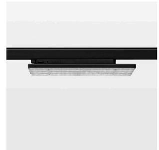
Aufbauleuchte mit LED, Bemessungslebensdauer der LED L90/B50 50000 h (Tambient 25°C), Farbwiedergabeindex CRI > 80, Farborttoleranz 3 SDCM (initial), homogenes Lichtbild 30°, TIR-Linse aus PMMA, Leuchtgehäuse Stahlblech, pulverbeschichtet, schwarz, Rastmechanismus zum exakten Ausrichten in 15°-Stufen, Drehwinkel 300°, In-Track-Adapter, On/Off, 220-240 V~ / 50-60 Hz, max. Anzahl Leuchten pro Stromkreis 27 Stk. / B16A
