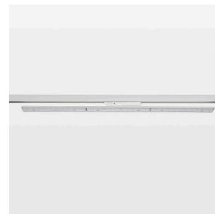
Aufbauleuchte mit LED, Bemessungslebensdauer der LED L90/B50 50000 h (Tambient 25°C), Farbwiedergabeindex CRI > 80, Farborttoleranz 3 SDCM (initial), homogenes Lichtbild 30°, TIR-Linse aus PMMA, Leuchtgehäuse Stahlblech, pulverbeschichtet, weiß, Rastmechanismus zum exakten Ausrichten in 15°-Stufen, Drehwinkel 300°, In-Track-Adapter, Casambi, On/Off, 220-240 V~ / 50-60 Hz
