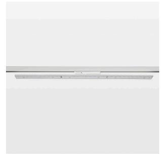
Aufbauleuchte mit LED, Bemessungslebensdauer der LED L90/B50 50000 h (Tambient 25°C), Farbwiedergabeindex CRI > 80, Farborttoleranz 3 SDCM (initial), homogenes Lichtbild 30°, TIR-Linse aus PMMA, Leuchtengehäuse Stahlblech, pulverbeschichtet, weiß, Rastmechanismus zum exakten Ausrichten in 15°-Stufen, Drehwinkel 300°, In-Track-Adapter, Casambi, On/Off, 220-240 V~ / 50-60 Hz
