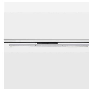
Aufbauleuchte mit LED, Bemessungslebensdauer der LED L90/B50 50000 h (Tambient 25°C), Farbwiedergabeindex CRI > 80, Farborttoleranz 3 SDCM (initial), doppelt asymmetrisches Lichtbild mit leichter horizontaler Aufhellung, Kombination aus asymmetrischen PMMA Linsen und 60° TIR Linsen aus PMMA, Leuchtgehäuse Stahlblech, pulverbeschichtet, silber, Rastmechanismus zum exakten Ausrichten in 15°-Stufen, Drehwinkel 300°, In-Track-Adapter, Casambi, 220-240 V~ / 50-60 Hz,
