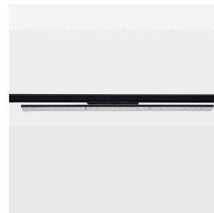
Aufbauleuchte mit LED, Bemessungslebensdauer der LED L90/B50 50000 h (Tambient 25°C), Farbwiedergabeindex CRI > 80, Farborttoleranz 3 SDCM (initial), doppelt asymmetrisches Lichtbild mit leichter horizontaler Aufhellung, Kombination aus asymmetrischen PMMA Linsen und 60° TIR Linsen aus PMMA, Leuchtgehäuse Stahlblech, pulverbeschichtet, schwarz, Rastmechanismus zum exakten Ausrichten in 15°-Stufen, Drehwinkel 300°, In-Track-Adapter, Casambi, 220-240 V~ / 50-60 Hz,
