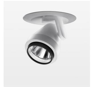
Halbeinbauleuchte mit LED, Bemessungslebensdauer der LED L80/B10 50000 h (Tambient 25°C), Farbwiedergabeindex CRI > 80, Farborttoleranz 2 SDCM (initial), rotationssymmetrischer Reflektor mit kreisförmigen Lichtbild, Reflektor Reinstaluminium 99,99% in MIRO-Silver®, segmentiert und facettiert, LED Hybrid-Technologie, 3D-Linse Silikon zur Reduzierung des Streulichtanteils, Aluminium-Druckguss, pulverbeschichtet, Drehwinkel 400°, Schwenkwinkel +/- 85°, weiß, separate Treibereinheit
