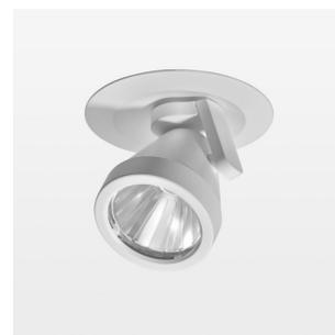
Halbeinbauleuchte mit LED, Bemessungslebensdauer der LED L80/B10 50000 h (Tambient 25°C), Farbwiedergabeindex CRI > 90, Farborttoleranz 3 SDCM (initial), rotationssymmetrischer Reflektor mit kreisförmigen Lichtbild, Reflektor Reinstaluminium 99,99% in MIRO-Silver®, segmentiert und facettiert, LED Hybrid-Technologie, 3D-Linse Silikon zur Reduzierung des Streulichtanteils, Aluminium-Druckguss, pulverbeschichtet, Drehwinkel 400°, Schwenkwinkel +/- 85°, weiß, separate Treibereinheit
