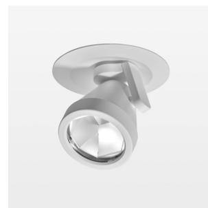
Halbeinbauleuchte mit LED, Bemessungslebensdauer der LED L80/B10 50000 h (Tambient 25°C), Farbwiedergabeindex CRI > 90, Farborttoleranz 2 SDCM (initial), Reflektor mit ovalem Lichtbild, Reflektor Reinstaluminium 99,99% in MIRO-Silver®, segmentier, Aluminium-Druckguss, pulverbeschichtet, Drehwinkel 400°, Schwenkwinkel +/- 85°, weiß, Potentiometer zur Helligkeitseinstellung, separate Treibereinheit
