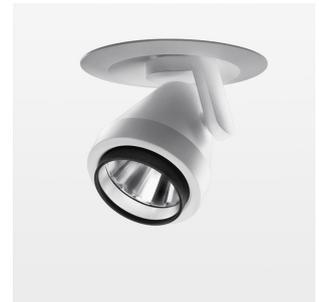
Halbeinbauleuchte mit LED, Bemessungslebensdauer der LED L80/B10 50000 h (Tambient 25°C), Farbwiedergabeindex CRI > 96, Farborttoleranz 2 SDCM (initial), rotationssymmetrischer Reflektor mit kreisförmigen Lichtbild, Reflektor Reinstaluminium 99,99% in MIRO-Silver®, segmentiert und facettiert, LED Hybrid-Technologie, 3D-Linse Silikon zur Reduzierung des Streulichtanteils, Aluminium-Druckguss, pulverbeschichtet, Drehwinkel 400°, Schwenkwinkel +/- 85°, weiß, separate Treibereinheit
