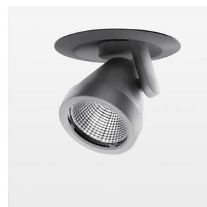
Halbeinbauleuchte mit LED, Bemessungslebensdauer der LED L80/B10 50000 h (Tambient 25°C), Farbwiedergabeindex CRI > 96, Farborttoleranz 2 SDCM (initial), rotationssymmetrischer Reflektor mit kreisförmigen Lichtbild, Reflektor Reinstaluminium 99,99% in MIRO-Silver®, segmentiert und facettiert, LED Hybrid-Technologie, 3D-Linse Silikon zur Reduzierung des Streulichtanteils, Aluminium-Druckguss, pulverbeschichtet, Drehwinkel 400°, Schwenkwinkel +/- 85°, silber, separate Treibereinheit
