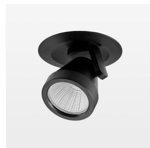
Halbeinbauleuchte mit LED, Bemessungslebensdauer der LED L80/B10 50000 h (Tambiant 25°C), Farbwiedergabeindex CRI > 80, Farborttoleranz 2 SDCM (initial), rotationssymmetrischer Reflektor mit kreisförmigen Lichtbild, Reflektor Reinstaluminium 99,99% in MIRO-Silver®, segmentiert und facettiert, Aluminium-Druckguss, pulverbeschichtet, Drehwinkel 400°, Schwenkwinkel +/- 85°, schwarz, Potentiometer zur Helligkeitseinstellung, separate Treibereinheit
