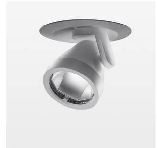
Halbeinbauleuchte mit LED, Bemessungslebensdauer der LED L80/B10 50000 h (Tambient 25°C), Farbwiedergabeindex CRI > 80, Farborttoleranz 2 SDCM (initial), Reflektor mit ovalem Lichtbild, Reflektor Reinstaluminium 99,99% in MIRO-Silver®, segmentiert, Aluminium-Druckguss, pulverbeschichtet, Drehwinkel 400°, Schwenkwinkel +/- 85°, silber, separate Treibereinheit
