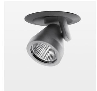
Halbeinbauleuchte mit LED, Bemessungslebensdauer der LED L80/B10 50000 h (Tambient 25°C), Farbwiedergabeindex CRI > 80, Farborttoleranz 2 SDCM (initial), rotationssymmetrischer Reflektor mit kreisförmigen Lichtbild, Reflektor Reinstaluminium 99,99% in MIRO-Silver®, segmentiert und facettiert, LED Hybrid-Technologie, 3D-Linse Silikon zur Reduzierung des Streulichtanteils, Aluminium-Druckguss, pulverbeschichtet, Drehwinkel 400°, Schwenkwinkel +/- 85°, silber, separate Treibereinheit
