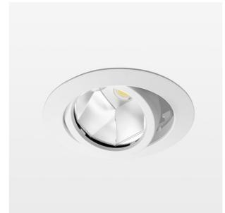
Einbauleuchte mit LED, Bemessungslebensdauer der LED L80/B10 50000 h (Tambient 25°C), Farbwiedergabeindex CRI > 90, Farborttoleranz 2 SDCM (initial), Reflektor mit ovalem Lichtbild, Reflektor Reinstaluminium 99,99% in MIRO-Silver®, segmentiert, Aluminium-Druckguss, pulverbeschichtet, Drehwinkel, Schwenkwinkel +/- 25°, weiß,
