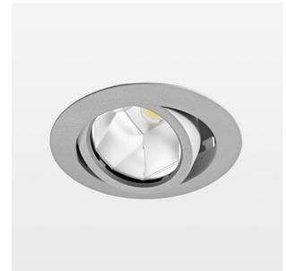
Einbauleuchte mit LED, Bemessungslebensdauer der LED L80/B10 50000 h (Tambient 25°C), Farbwiedergabeindex CRI > 80, Farborttoleranz 2 SDCM (initial), Reflektor mit ovalem Lichtbild, Reflektor Reinstaluminium 99,99% in MIRO-Silver®, segmentiert, Aluminium-Druckguss, pulverbeschichtet, Drehwinkel, Schwenkwinkel +/- 25°, silber,
