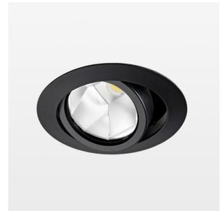
Einbauleuchte mit LED, Bemessungslebensdauer der LED L80/B10 50000 h (Tambient 25°C), Farbwiedergabeindex CRI > 96, Farborttoleranz 2 SDCM (initial), Reflektor mit ovalem Lichtbild, Reflektor Reinstaluminium 99,99% in MIRO-Silver®, segmentiert, Aluminium-Druckguss, pulverbeschichtet, Drehwinkel, Schwenkwinkel +/- 25°, schwarz,
